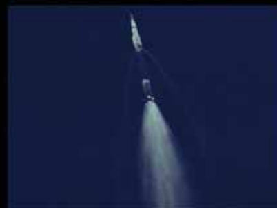
H + 9min 08s - Séparation du 2ème étage
